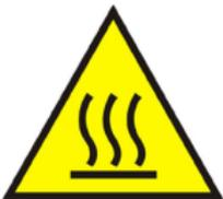
Situazioni di pericolo: Quando si transita o lavora nelle vicinanze di attrezzature che producono calore (lance termiche, fiamma ossidrica, saldatrici, motori a scoppio, ecc.) o macchine funzionanti con motori (generatori elettrici, compressori, ecc.); quando si effettuano lavorazioni con sostanze ustionanti.
